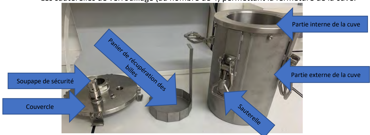
Les éléments de la cuve double peau
