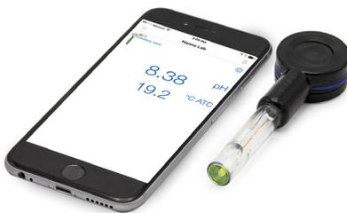
Le module électronique n'est pas étanche : éviter les projections d'eau et une utilisation dans un environnement humide ou à forte condensation
