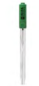
HI1131B Électrode pH combinée, corps en verre, à bulbe sphérique, à remplissage, connecteur BNC, câble 1 m
