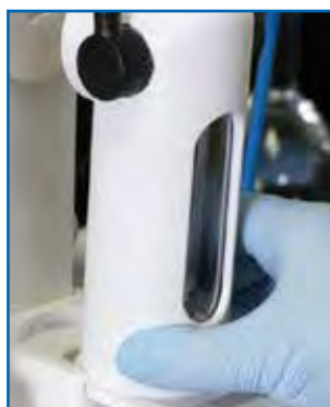
Installation de la burette rapide et sûre avec système Clip Lock
