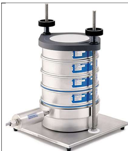
UP200St-TS avec sonotrode en cercle et tour de tamis
