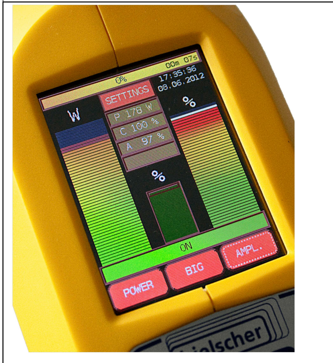
Ecran tactile couleur de commande et de visualisation des paramètres pendant le travail :
