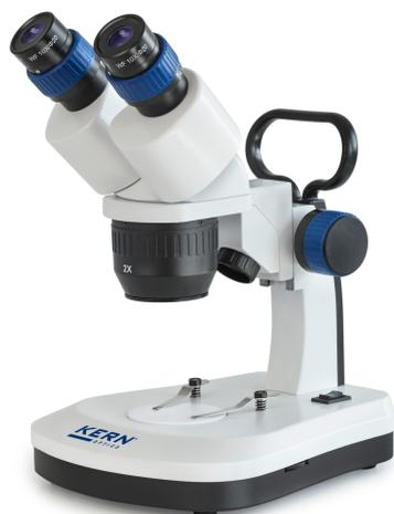
Mécanisme de focalisation vis macrométrique
