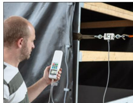
Dynamomètre digital universel pour mesures de force en traction et compression avec cellule de mesure externe
