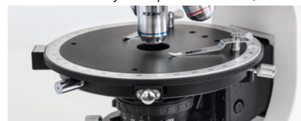
Platine à polarisation, centrable et rotatif
