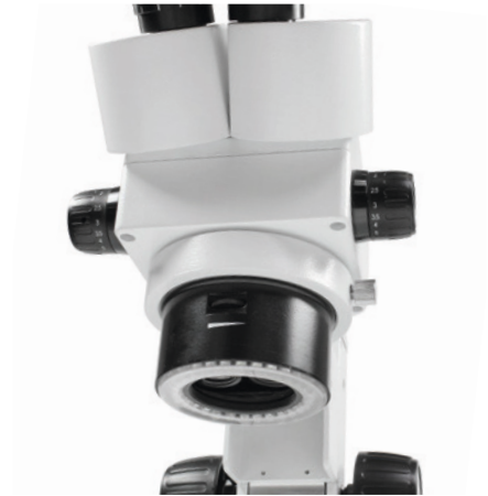
Anneau lumineux LED intégré à intensité variable
