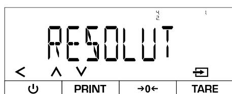
⇒ En appuyant une nouvelle fois sur la touche de confirmation, on accède au niveau de réglage de l'application sélectionnée.
