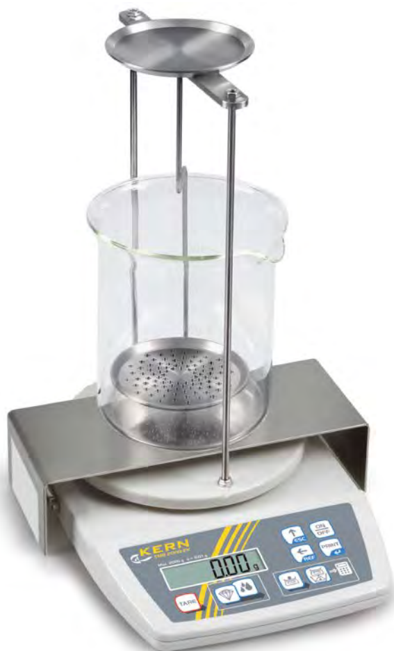
Fig.1: KERN EMB 2000-2V avec kit de densité installé KERN YDB-02
