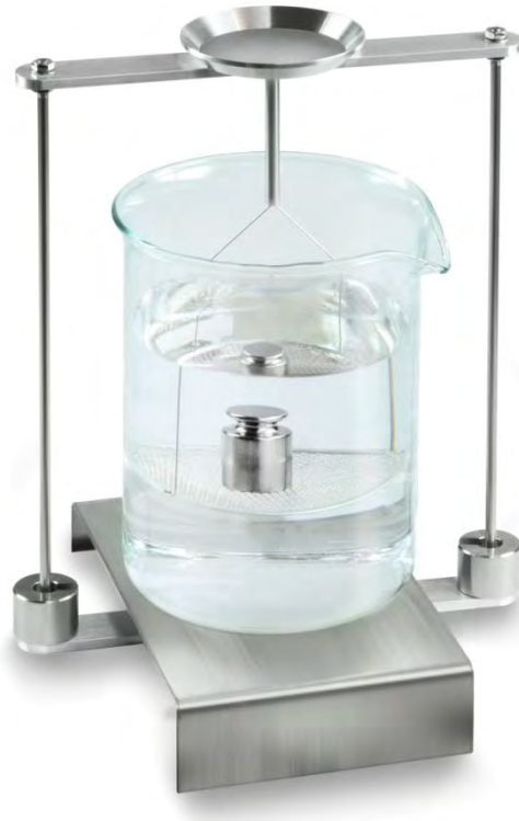
Fig.6: Pesée en liquide de contrôle La balance extrapole la densité du liquide et l'affiche.
