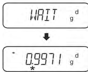
Fig.6: Pesée en liquide de contrôle La balance extrapole la densité du liquide et l'affiche.
