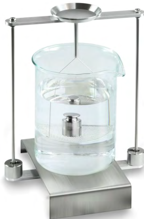
Fig.6: Pesée en liquide de contrôle La balance extrapole la densité du liquide et l'affiche.
