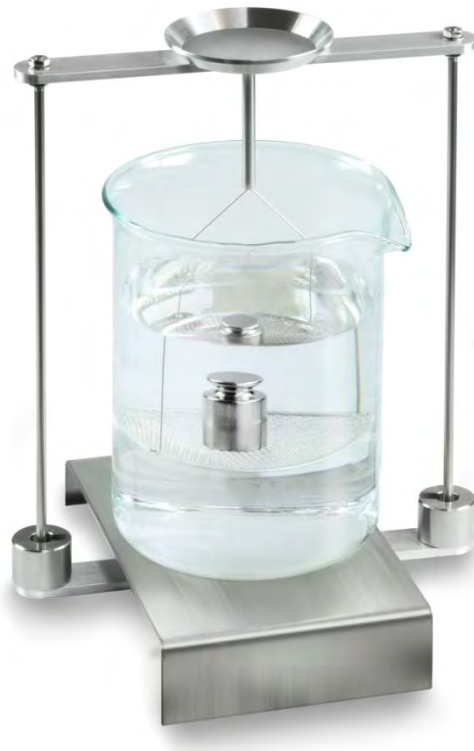
Fig. 2 : Pesée dans un liquide examiné
