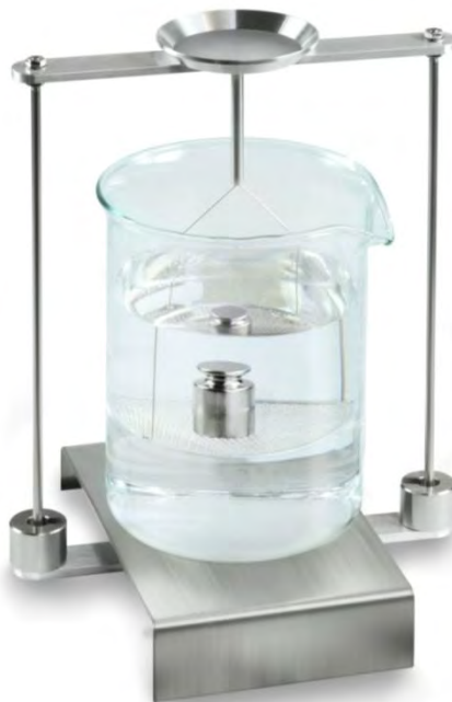
Afb. 2: “In de meetvloeistof wegen”
