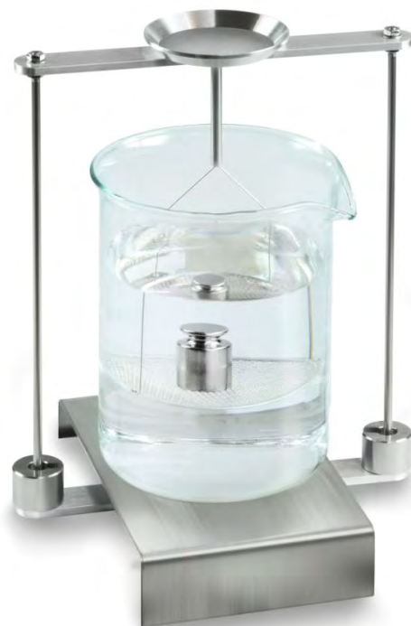
Afb. 6: In de meetvloeistof wegen
