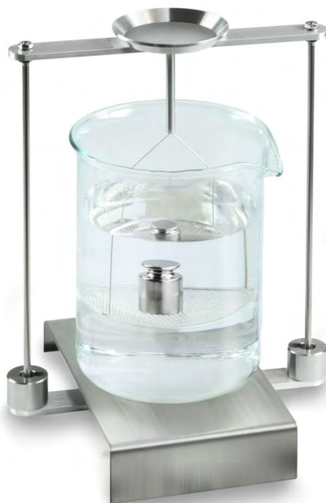
Afb. 2: In de testvloeistof wegen
