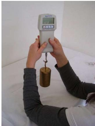
5. Cette position est maintenue jusqu'à ce que "F" apparaisse sur l'écran. Le poids peut alors être retiré et le réglage est terminé. Si toutefois "E" apparaît sur l'écran - répéter les étapes **1 à 5** jusqu'à ce que "F" confirme la réussite de l'ajustage.
