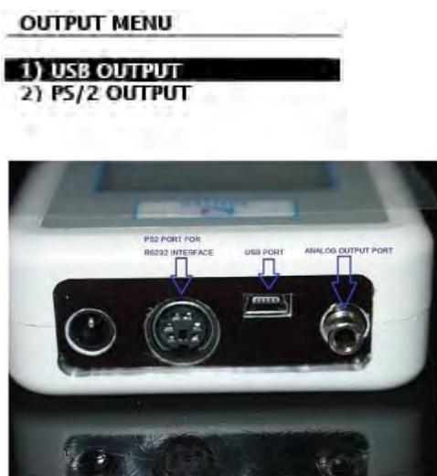
Il y a une sortie analogique sur l'appareil. Cela génère un signal qui va de +2V à -2V. Ce signal est un pourcentage de la valeur maximale du dynamomètre. E.G. : FL100 50N sont mesurés dans le sens de la tension, alors un signal -1 V est présent sur la sortie analogique. 75N en compression, alors + 1.5V est présent à la sortie analogique. Si l'instrument est en mode PASS - Fail, la sortie analogique est de 2V pour PASS et 0V pour FAIL.
