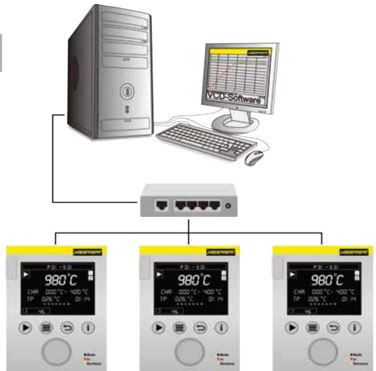
Exemple de montage avec 3 fours
