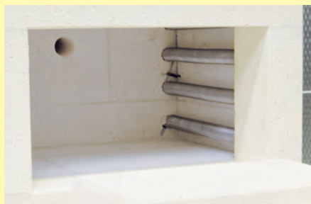
Intérieur du four avec isolation en briques réfractaires légères de qualité supérieure
