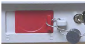
Verrouillé avec un plomb de sécurité
