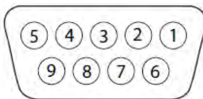
Figura 2-1. Patillas de RS232
