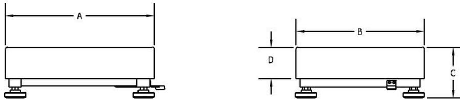
Figure 1. Schéma de dimension de base Defender
