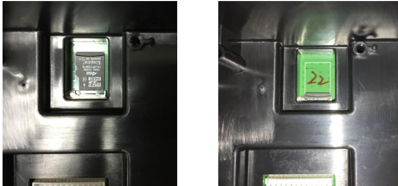
Abbildung 2-5 Einschieben einer SD-Karte in die SD-Buchse (links); SD-Karte installiert (rechts)
