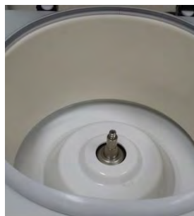
Eje del motor y cámara
