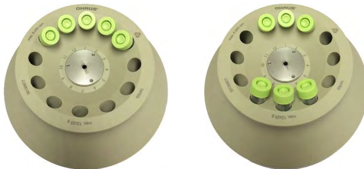
Abbildung.13-1 FALSCH Abbildung.13-2 KORREKT (6 Röhrrchen)
