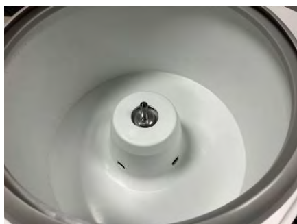
Arbre et chambre du moteur
