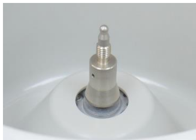
Arbre et chambre du moteur
