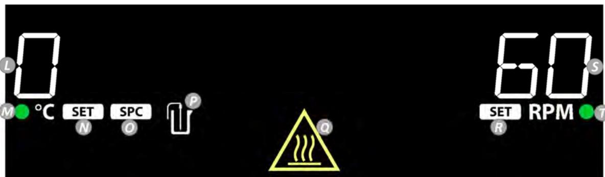
**L. Teplota ohřevu:** Přepne na teplotu externí sondy jakmile je sonda zapojena a P se rozsvítí.
