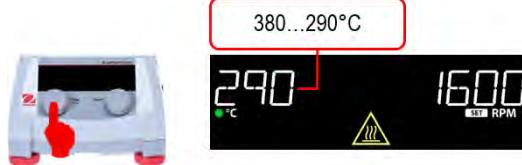
4. Para apagar el calentador, mantenga pulsada la ruleta izquierda (C) hasta que la unidad emita un pitido y desaparezca el indicador del calentador (M).
