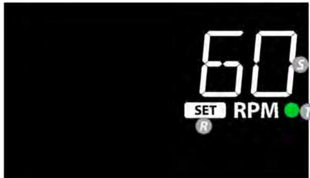
**R. Indicador de configuração de velocidade:** Acende até o agitador atingir a Configuração de Velocidade (S).
