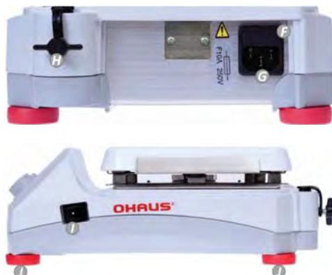
**G. Modul vstupu napájení (PEM)****H. Knoflík pro přidatnou tyčku****I. Přepínač to režimu spánku****J. Nožky:** Nejsou nastavitelné
