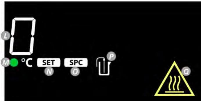
**L. Temperatura do aquecedor:** Alterna para a temperatura da sonda externa quando a sonda está conectada e P acende.
