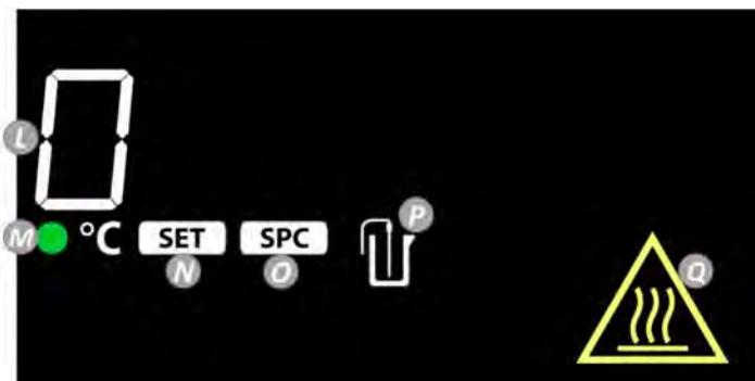
**L. Varmeelementets temperatur:** Endres til utvendig sondetemperatur når tilkoblet og P lyser.
