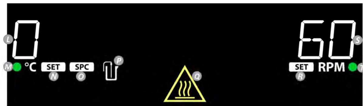
**L. VarmevarmerTemperatur:** Skifter til ekstern sondetemperatur, når sonden er tilsluttet, og P lyser.
