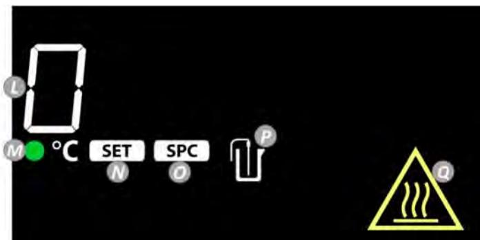
**L. Värme temperatur:** Byt till extern sondtemperatur när sonden är ansluten och P tänds.
