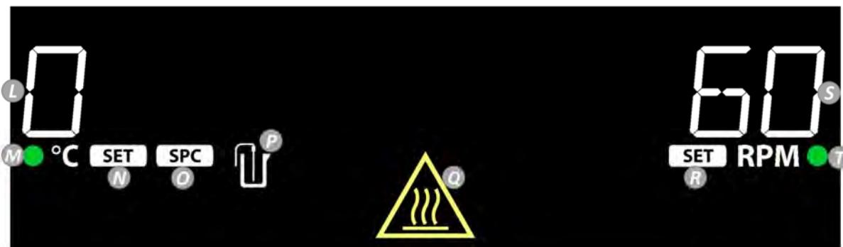
**L. Värme temperatur:** Byt till extern sondtemperatur när sonden är ansluten och P tänds.
