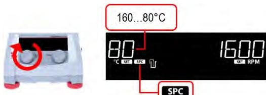
29. Pressione e segurar o botão a esquerdo (C) até que o dispositivo emite bipes e os acende indicador aquecedor (M).
