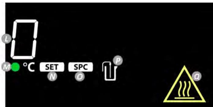
**L. Teplota ohřevu:** Přepne na teplotu externí sondy jakmile je sonda zapojena a P se rozsvítí.
