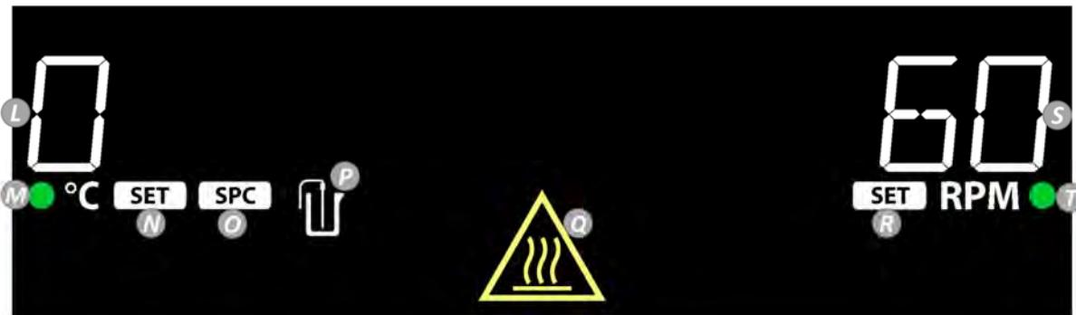
L. 实际温度: 当外接温度探头接上时切换到探头温度且 P 会亮起
