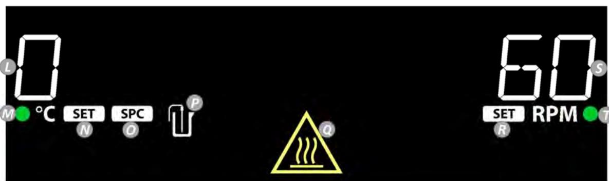
**L. Lämmittimen lämpötila:** Mittaa anturin ulkosen lämpötilan, kun se on kytketty ja P on päällä.
