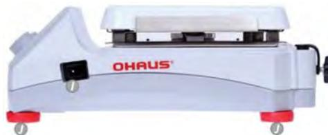
**A. Skjerm****B. Dvaleindikator****D. Knott:** Kontrollerer hastighet**F. Sikring****G. Strøminngang (PEM)****H. Bundet knott for tilbehørsstav****I. Av/På-bryter****J. Føtter:** Ikke justerbare
