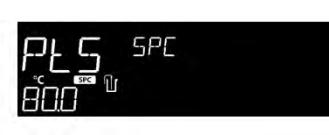
18. Appuyez sur le bouton gauche (C) et maintenez-le enfoncé jusqu'à ce que l'appareil émette un signal sonore pour commencer le SPC à cette température.
