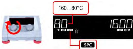
29. Halten Sie den linken Knopf (C) gedrückt, bis das Gerät einen Piepton abgibt und die Heizfunktionsanzeige (M) aufleuchtet.
