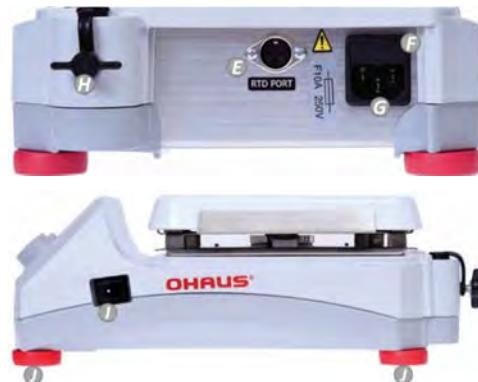
**A. Bildschirm anzeigen****B. Standby-Anzeige****C. Drehknopf:** Steuert die Temperatur und das Einstellungsmenü**E. Externer RTD-Sondenanschluss****F. Sicherung****G. Leistungseinspeisungsmodul (PEM)****H. Gewindeknopf für Zubehörstange****I. Standby-Schalter****J. Füße:** Nicht einstellbar
