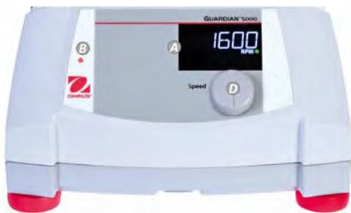
**A. Displej****B. Indikátor zapojení****D. Knoflík:** Ovládá rychlosť**F. Pojistka**
