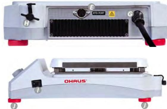
**A. Schermo del display****B. Indicatore di standby****C. Manopola sinistra:** controlla la temperatura e il menu delle impostazioni**D. Manopola destra:** controlla la velocità**E. Porta esterna per sonda RTD****G. Cavo di alimentazione****H. Manopola filettata per asta accessori****I. Interruttore di standby****J. Piedi:** non regolabili
