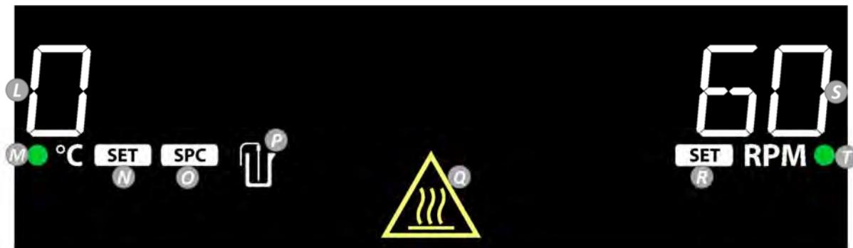
**L. Température de l'élément chauffant:** bascule sur la température de la sonde externe lorsque celle-ci est branchée et que P est allumé.
