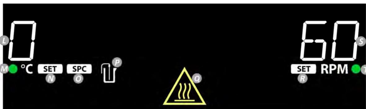
**L. A fűtőegység hőmérséklete:** Ha mérőegység van csatlakoztatva és a P világít, a külső mérőcsúcs hőmérsékletére vált.
