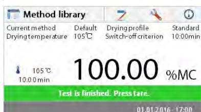
L'affichage indique le nom de la méthode, la température / l'heure, le poids initial, la température réelle, la durée écoulé de l'essai, l'humidité et la courbe. Le test arrête automatiquement à la fin de l'analyse.
