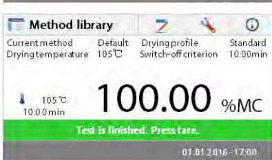
Il display indica nome del metodo, temperatura/tempo, peso iniziale, temperatura effettiva, tempo trascorso nel test, umidità e curva. Il test si arresta automaticamente alla fine della misurazione.
