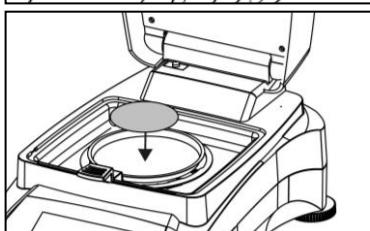
Coloque la bandeja de muestras vacía y la bandeja de fibra de vidrio en el asa / tirador de la bandeja. La bandeja de muestras debe colocarse plana dentro del asa / tirador de la bandeja.
