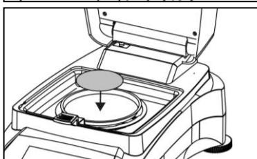
Placer la coupelle d'échantillon vide et le tampon en fibre de verre dans le porte-coupelle. La coupelle d'échantillon doit être à plat dans le porte-coupelle.
