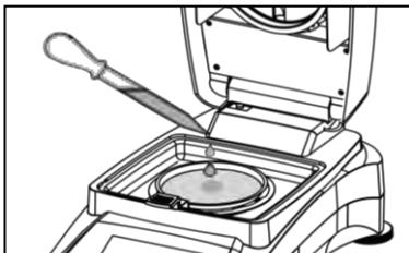
Öffnen Sie die Abdeckung des Feuchtigkeitsmessgeräts.
