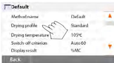
Appuyer sur les éléments de paramétrage pour les modifier. Se reporter au mode d'emploi pour plus de détails.
