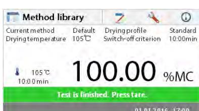
La pantalla muestra el nombre del método empleado, Temperatura / Tiempo. Peso Inicial, temperatura actual, tiempo de la prueba transcurrido, humedad y curva. La prueba se interrumpe automáticamente al concluir la medición.
