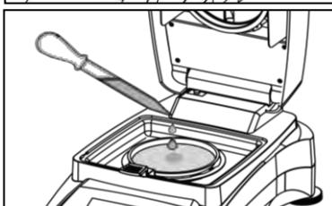
Aprire il coperchio dell'Analizzatore di Umidità.
