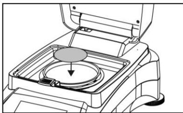
Legen Sie die leere Probenschale und Glasfaserschale in den Schalenhalter. Die Probenschale muss im Schalenhalter flach aufliegen.
