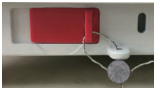
Bloccato con Sigillo di Cavo
