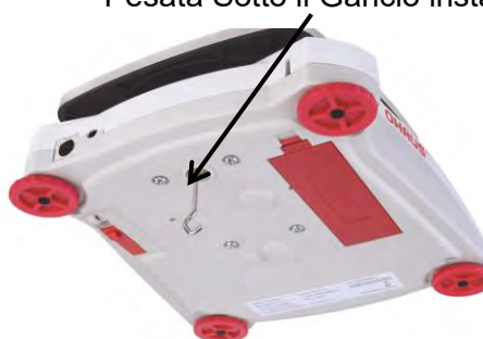
Pesata Sotto il Gancio installato
