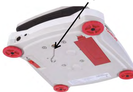
Pesata Sotto il Gancio installato
