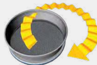
Principe du tamissage à chocs
