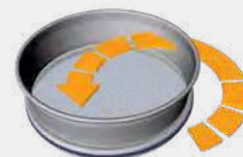
Principe du tamissage horizontal
