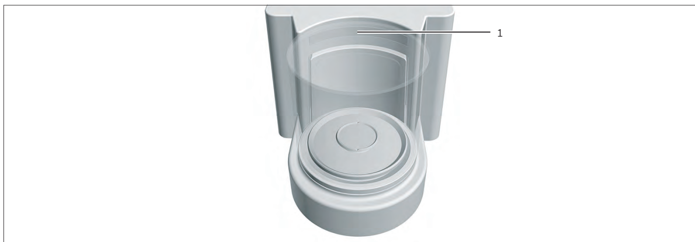
III. 7: Éclairage de la chambre de pesée (exemple)
