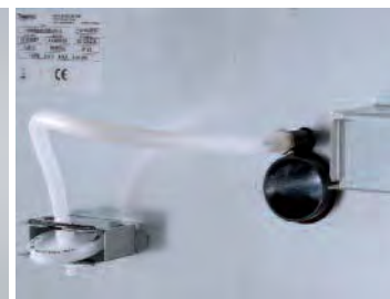
Filtre à particules
